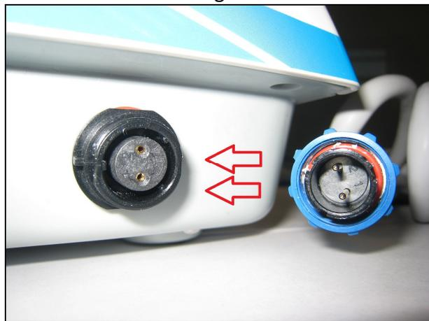
Fixez ensuite la connexion en tournant le fil plastique dans le sens des aiguilles d'une montre (Fig.5).
